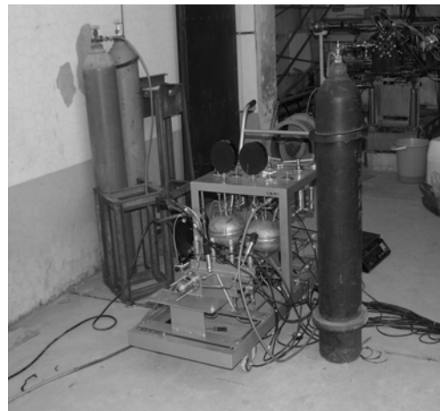
图 6 发动机实验系统
